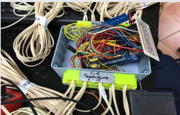
Figura 3. Tarjeta Arduino Mega con sensores y tarjeta Xbee.
